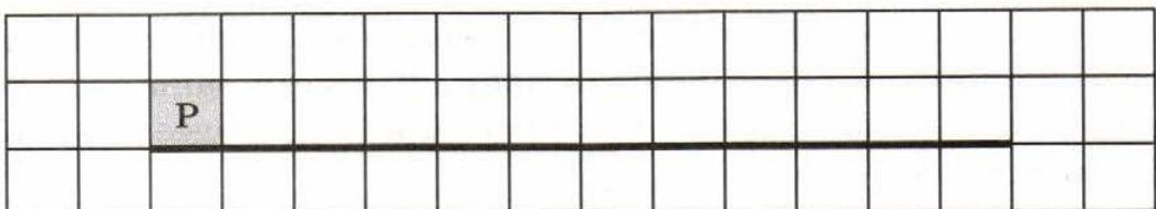
Робот должен закрасить все клетки, прилегающие к горизонтальной стене сверху (так, как это изображено на рисунке ниже). Конечное положение Робота значения не имеет.
